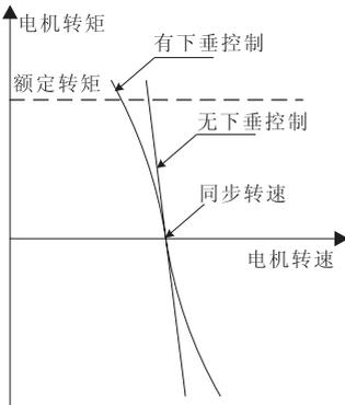
图6-20 下垂控制电机特性示意图
