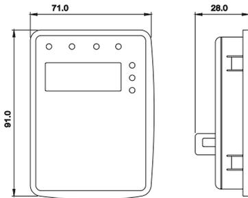
图 A-9 外引键盘（小）的安装尺寸
