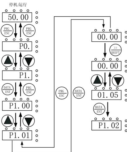
图 5-2 三级菜单操作流程图
