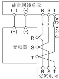
图 4-19 能量回馈单元连接图
