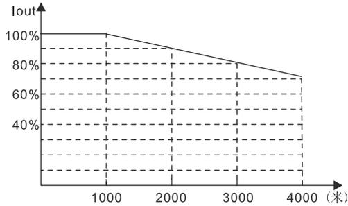
图 3-1 安装海拔高度与变频器降额曲线
