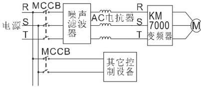
图 4-17 主回路电源侧连接图
