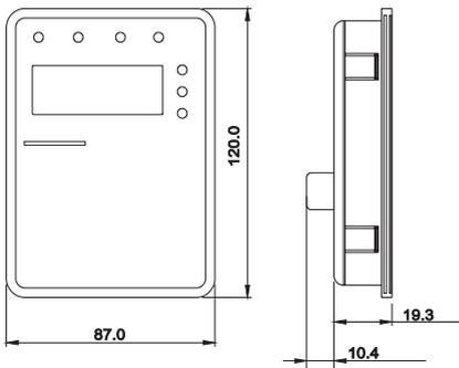
图 A-11 外引键盘（大）的安装尺寸
