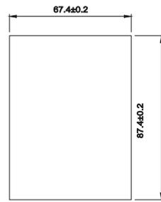
图 A-10 外引键盘（小）的开孔尺寸
