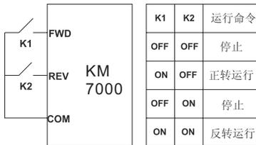
图 6-10 两线式控制（使能与方向分离）
