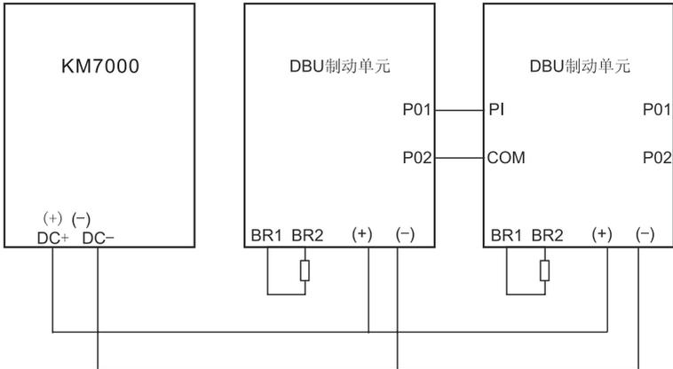
图 B-3 制动单元的并联连接
