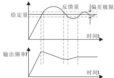
图 6-23 偏差极限与输出频率的对应关系
