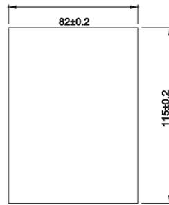
图 A-12 外引键盘（大）的开孔尺寸
