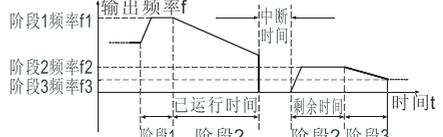
图6-26 简易PLC启动方式1
