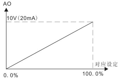
图 6-14 给定量与模拟量输出的对应关系
