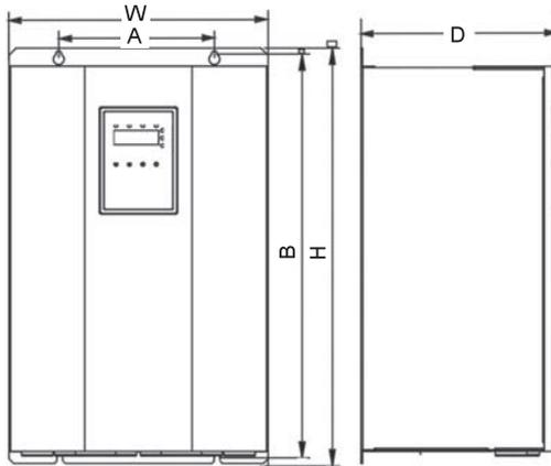
图 A-2 18.5~132KW 机型外形尺寸 (380V)
