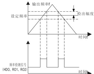
图6-19 频率到达检出幅值示意图
